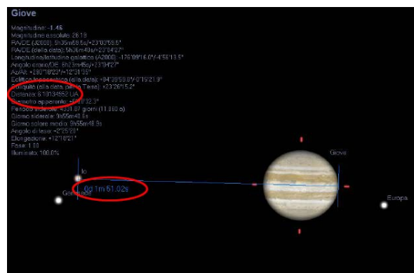
Fig. 2: Misura della separazione angolare tra Giove e Io utilizzando lo strumento “angular measure” di Stellarium.
